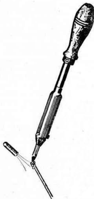
Fig. 127 - Buona norma prudenziale sarà quella di operare le saldature all'estremità dei terminali dei diodi e dei transistori.
